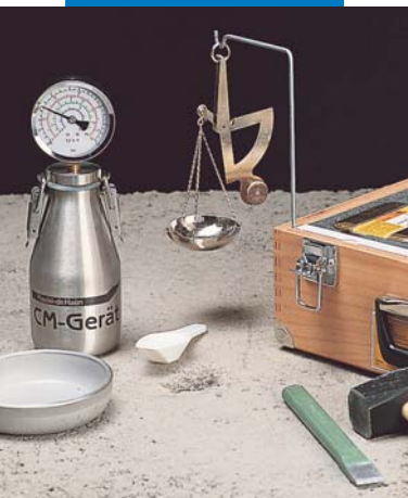
Misura di umidità di massetti in Mapecem con igrometro a carburo
